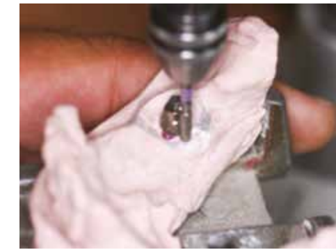
Figura 9. Fresado de los soportes protésicos con la ayuda de una fresadora; la fresa deberá ser especial para titanio y las paredes deberán tener un paralelismo no mayor los 4 grados.
